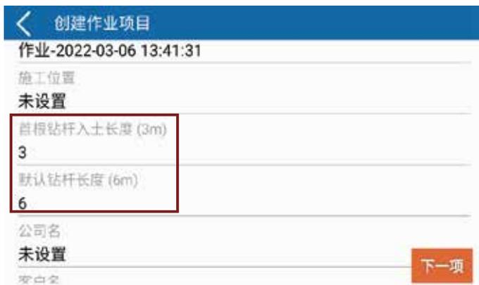
创建新作业文件时，必须准确输入钻杆长度，以保证数据的精准度。
