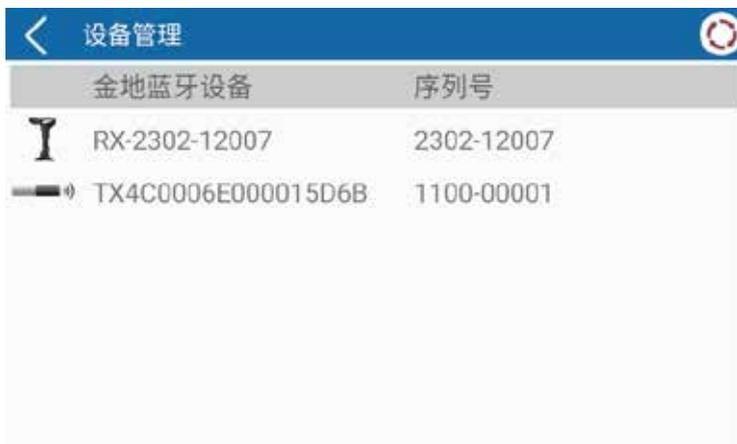
在此界面上，我们可以看到已连接的设备。显示了所连接的探棒和接收仪及其各自的序列号。如需解锁设备，请点击相应设备并进入下一个界面。
