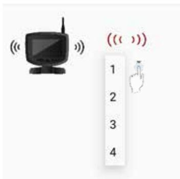
3. 如图所示，点击下拉箭头，从4个不同的无线电通道中进行选择。接收仪和遥显仪必须在同一通道上才能进行通信。
