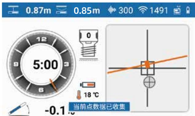
钻杆数显示器将显示0，表示第一个数据点
